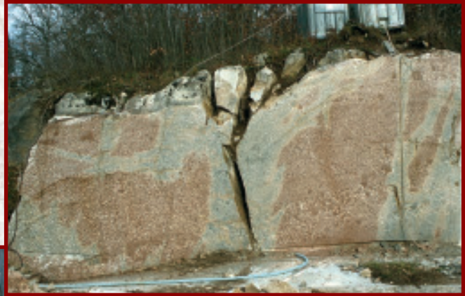
Unten: Herstellen des vertikalen Bohrlochs zur Aufnahme des Seils, Wimbergbruch Kiefer
