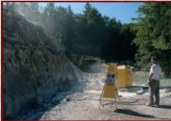
Tropfmarmor-Gewinnung mit der Diamantseilsäge im Eisenmannbruch Deisl
