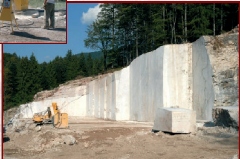
Tropfmarmor-Gewinnung mit der Diamantseilsäge im Eisenmannbruch Deisl
